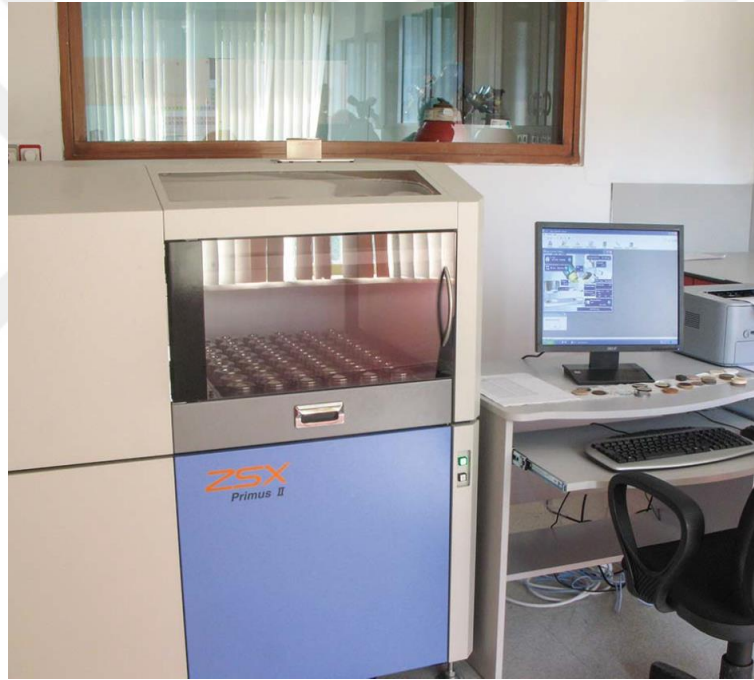
Şekil 3.3. Dalga boyu dağılımlı X-ışını floresans spektrometresi (WDXRF). (Marka: Rigaku, Model: ZSX Primus II)
