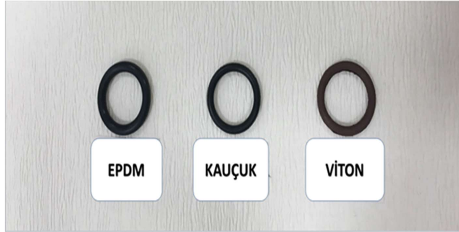
Şekil 4.19. Teflon hücrelerde kullanılan o-ring çeşitleri.
