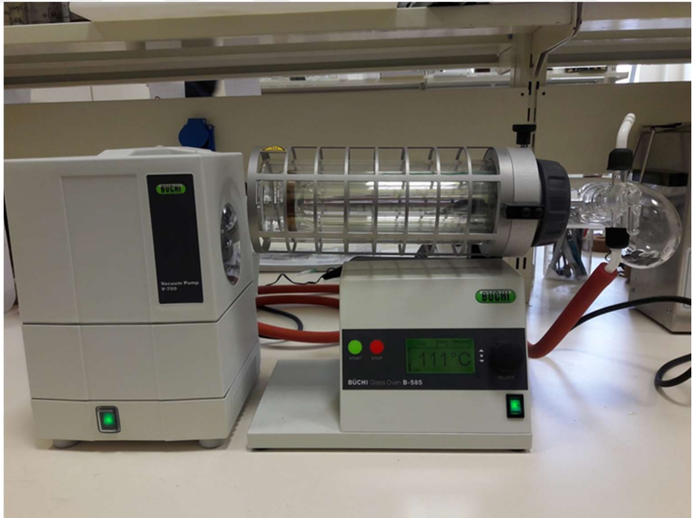
Şekil 3.5. Vakum pompalı sıcaklık ayarlı kurutma fırını.
