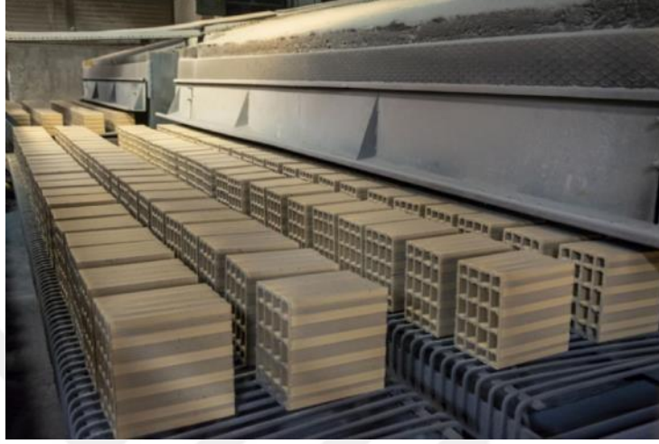
Şekil 2.4. Tuğlanın suni kurutulması (Web ileti 2, 2022)
