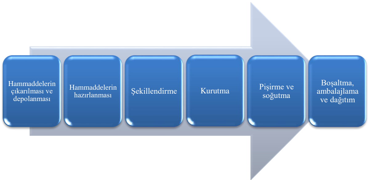
Şekil 2.1. Tuğlanın üretim prosesi (İriş, 2019)
