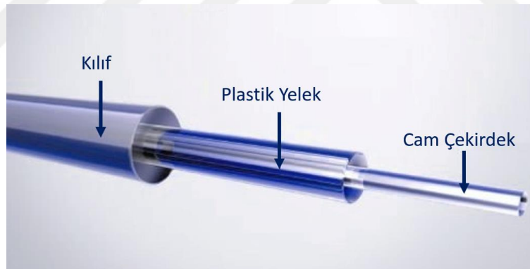
Şekil 3.3. PCS optik fiberin yapısı.
