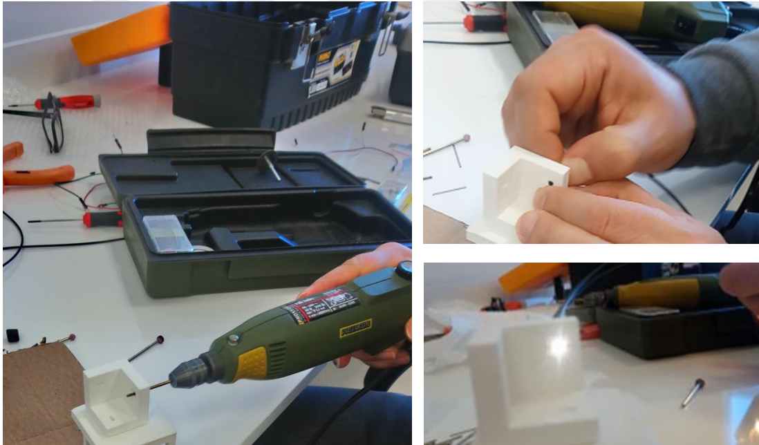
Şekil 4.9. Sabit parçaya POF kuplörün yerleştirilmesi.
