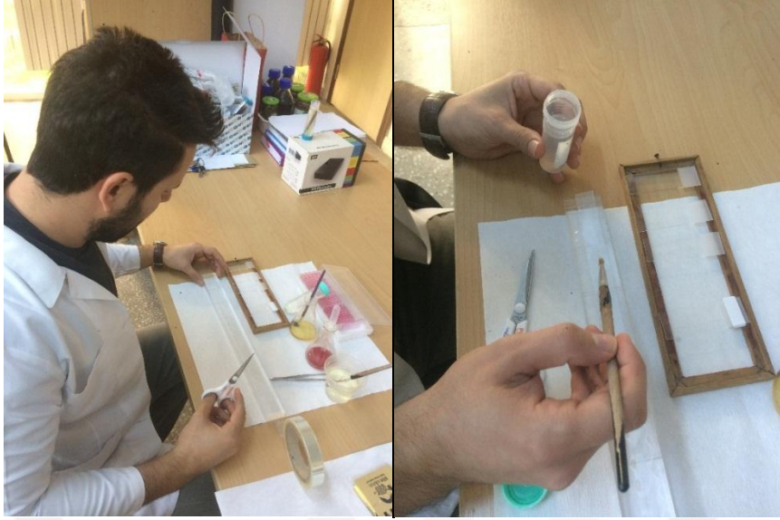
Şekil 3.8 Cihaza Yerleştirilecek Olan Bandın Kesimi ve Yapıştırıcının Sürülmesi
