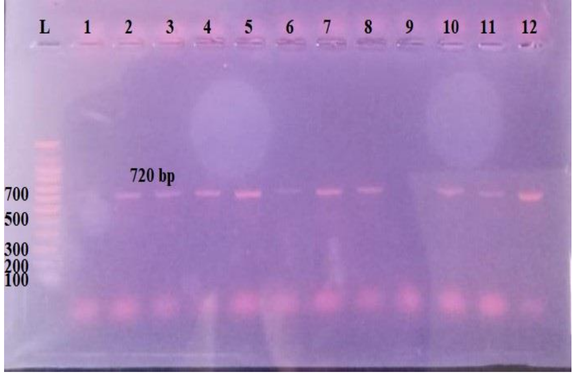
Şekil 4.1. 50 dakika boyunca 100 voltajda Red Safe lekeli (Intron, Kore) ile boyanmış %1,5 agaroz jel üzerinde CYP11A1 rs700519'un jel elektroforezi. Amplikonun moleküler boyutu 720 bp idi, L: Evrensel DNA merdiveni (Intron, Kore), 1 – 12: çoğaltılmış örnekler.
