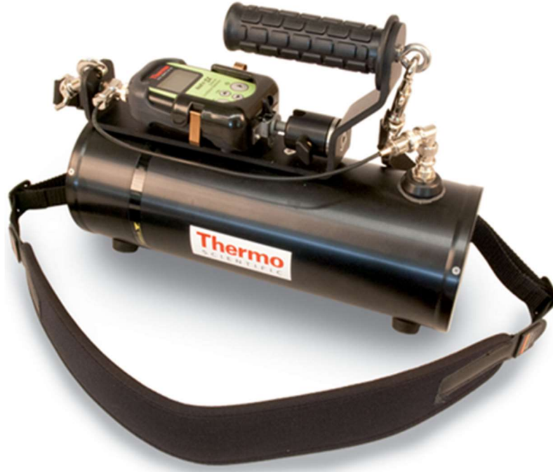
Şekil 3.2. FHZ 674 NBR model sintilasyon dedektörüne uyumlu Thermo Scientific RadEye SX marka taşınabilir dijital radyasyon ölçüm cihazı.
