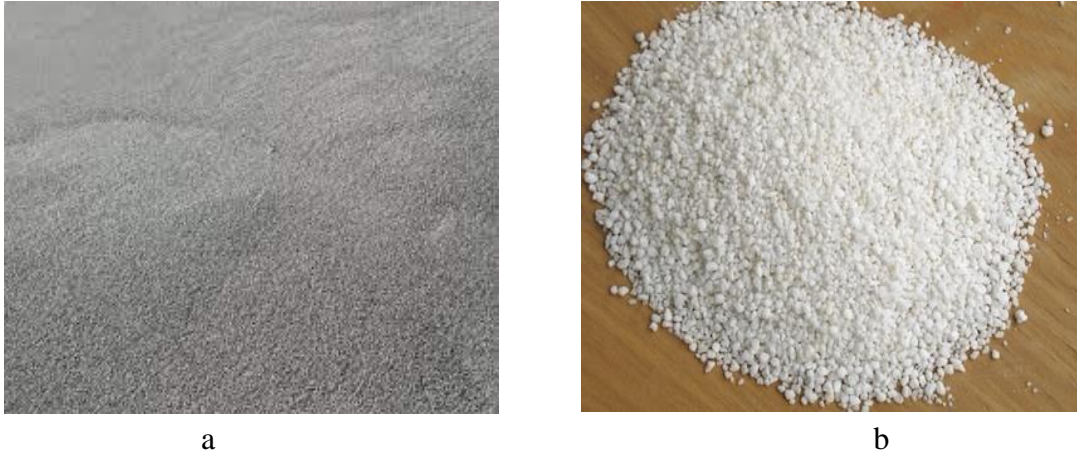
Şekil 1.1. a; Ham perlit, b; Genleştirilmiş perlit (URL 2)
