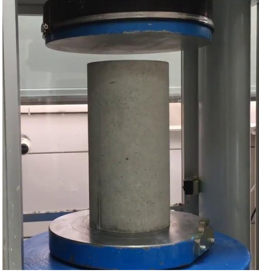
Şekil 3.11. Katkılı hafif beton numunelerinin yarmada çekme dayanımı
