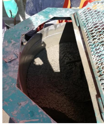
Şekil 3.6. Hafif beton hamurunun hazırlanması
