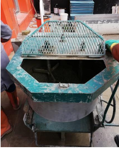
Şekil 3.6. Hafif beton hamurunun hazırlanması
