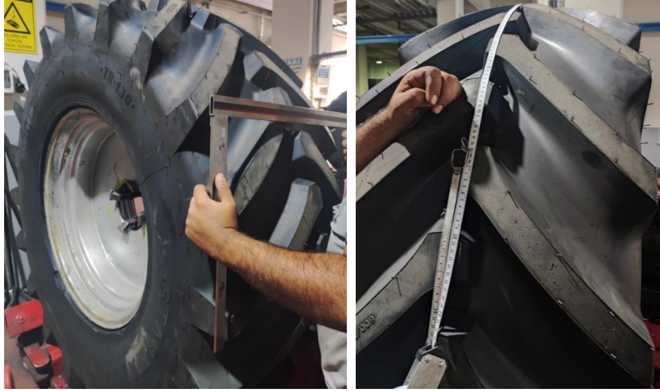
Şekil 3.4. Lastiklerin boyutsal ölçümleri
