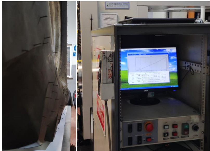
řekil 3.11. Lastiklerde sehım (deflection) deđerlerinin alınması
