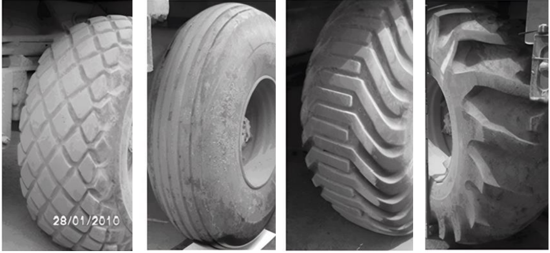
Şekil 2.11. Farklı tipte lastiklerin toprak sıkışmasına etkisi, a-) blok desenli diş profili, b) kaburga desenli diş profili, c-) düşük diş profili, d-) yüksek diş profilili lastik.
