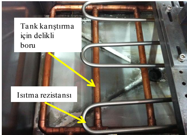
Şekil 2. Dielektrik tank sistemi (Dielectric tank system)
